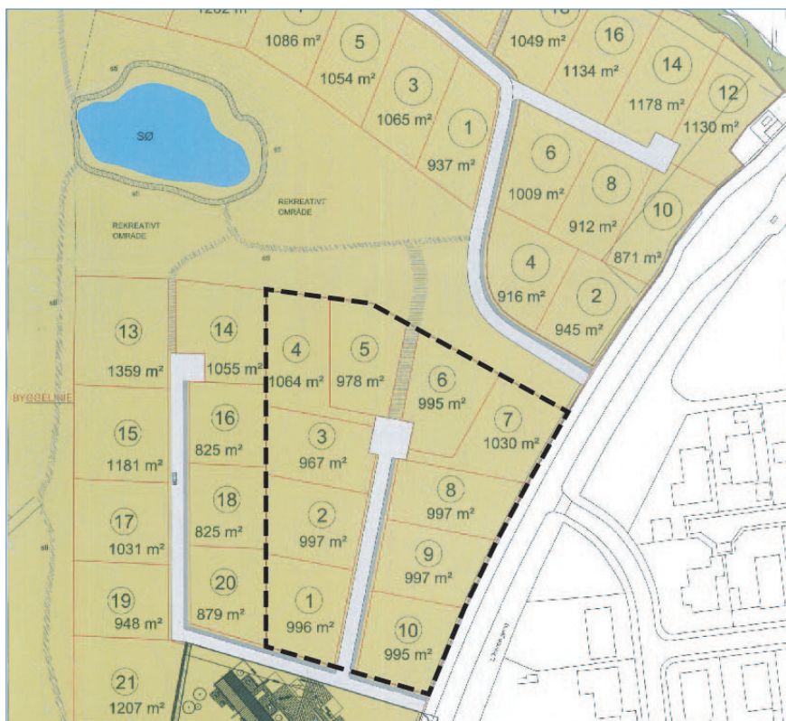
Fig. 10 Illustrationsplan der viser princip for vejstruktur, udstykning, og placering af bebyggelse.
